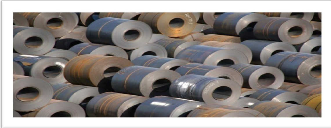
Figure 2 la bobine laminées à chaud
