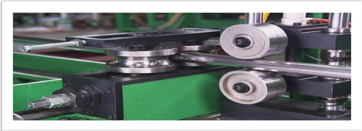
Figure 8 fabrication des profilées en acier
