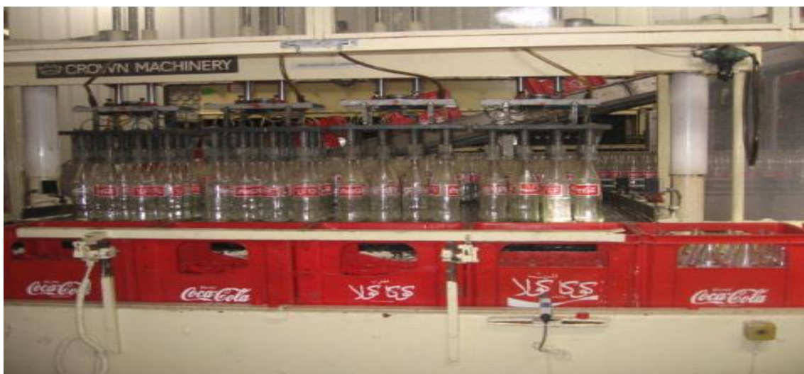
Figure 5 : Machine de décaissage
