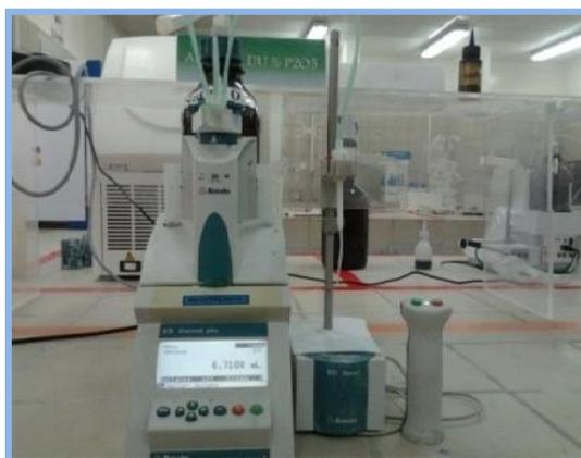
Figure IV-1: Titrage automatique
