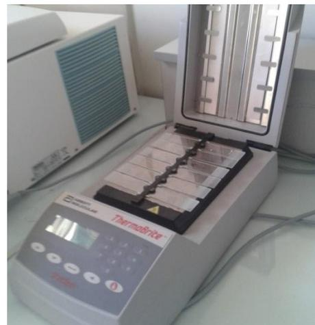
**Figure 17: ThermoBrite utilisé pour l'hybridation des sondes FISH**
