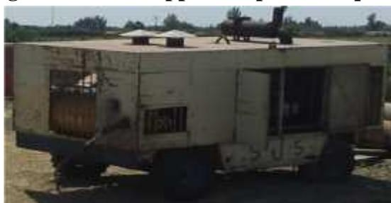
**Figure 46: Compresseur d'air**
