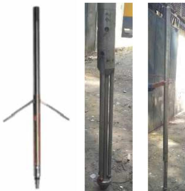
**Figure 35 : Sonde « diamètreur »**
