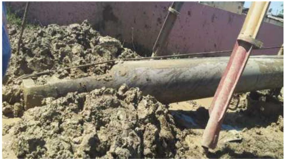
**Figure 20 : Récupérations des terrains argileux par la méthode de battage carottage**
