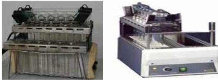
*Figure 7: les matras & l'appareil de minéralisation (Digesteur) de Buchi*
