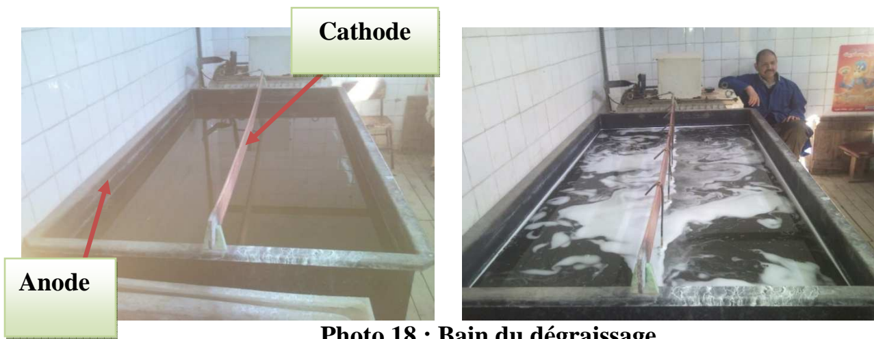
Photo 18 : Bain du dégraissage
