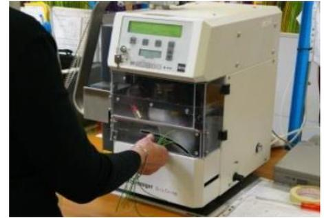
Figure 12 : Machine de sertissage Manuel
