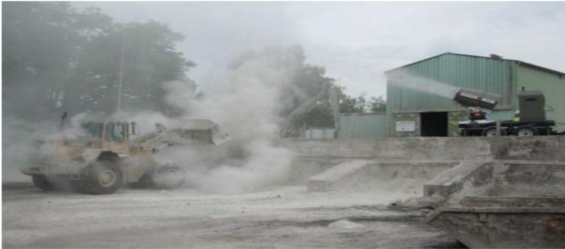
Figure 17 : Fonctionnement de DUST FIGHTER .
