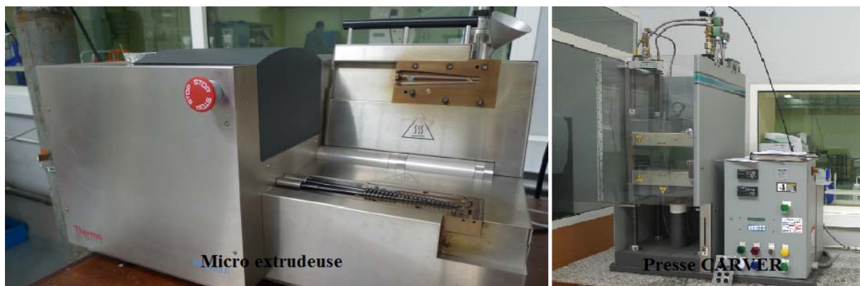
Fig.4. 12 : Micro extrudeuse et Presse CARVER
