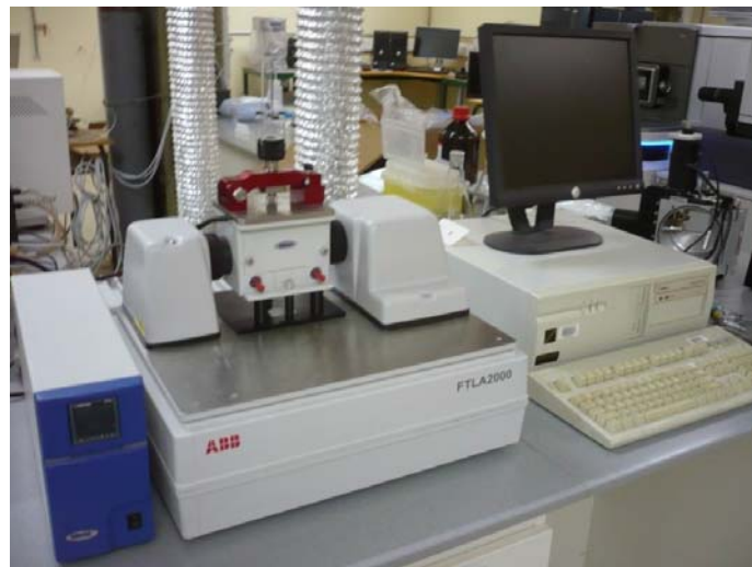
Fig.4. 8 : spectrophotomètre Infrarouge à transformée de Fourier
