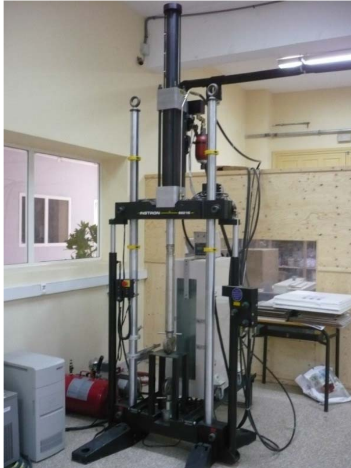
Fig.4. 13 : Appareil pour l'essai de traction « Instron »
