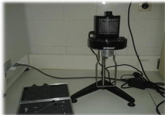
**Figure 7 : viscosimètre**
