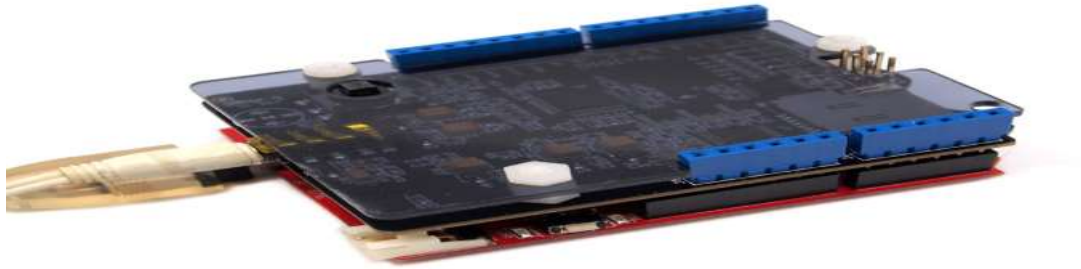
Figure 13: Carte connectée sur une carte Arduino pour lire des fichiers de musique
