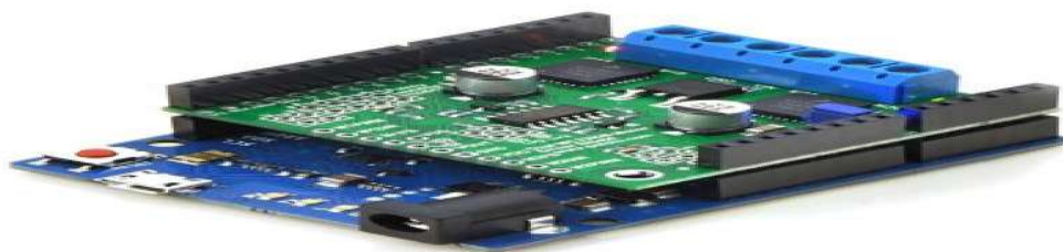
Figure 12: Carte électronique connectée sur Arduino pour contrôler des moteurs
