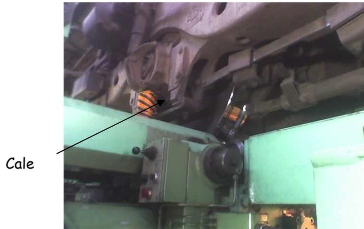
figure8 : soutien de l'essieu par une cale.
