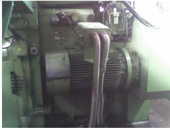
figure7 : moteur à entraînement des supports poulies
