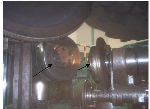
figure9.a : vue des deux galets d'entraînements
