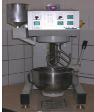
Figure 11 : Malaxeur du ciment
