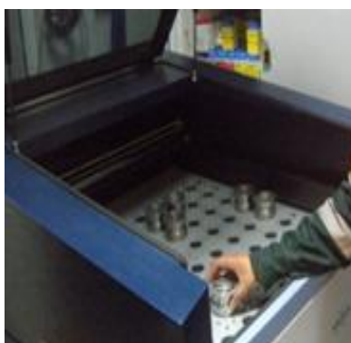
Figure 7 : Spectroscopie de fluorescence X
