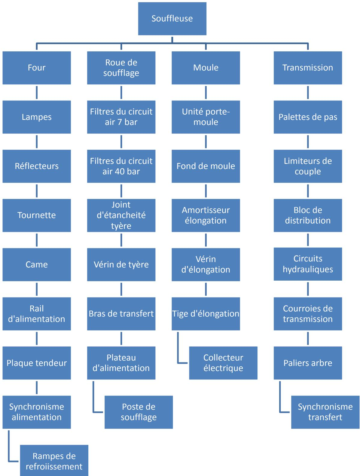
**FIGURE 10 : SCHÉMA DE DÉCOMPOSITION DE LA SOUFFLEUSE**
