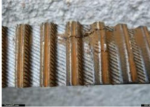
**FIGURE 15 : OXYDATION ET USURE DE LA COURROIE**
