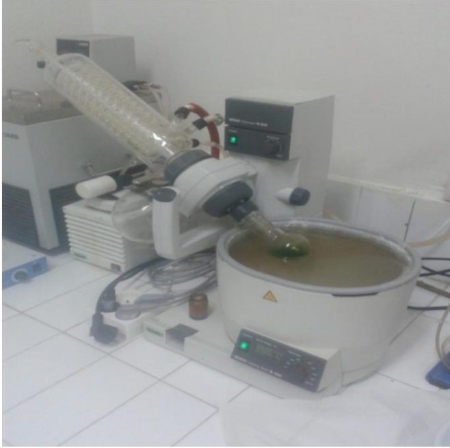
Annexe 1 : Concentration de l'extrait méthanolique de Matricaria chamomilla à l'aide d'un évaporateur rotatif.
