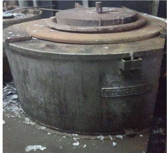
Au point de fusion, qui correspond à une température de 730°C pour l'AS12 et 780°C pour l'AS18, L'opérateur retire l'aluminium liquide à l'aide d'une louche et le verse dans des moules spécifiques au Bureau d'Etudes.
