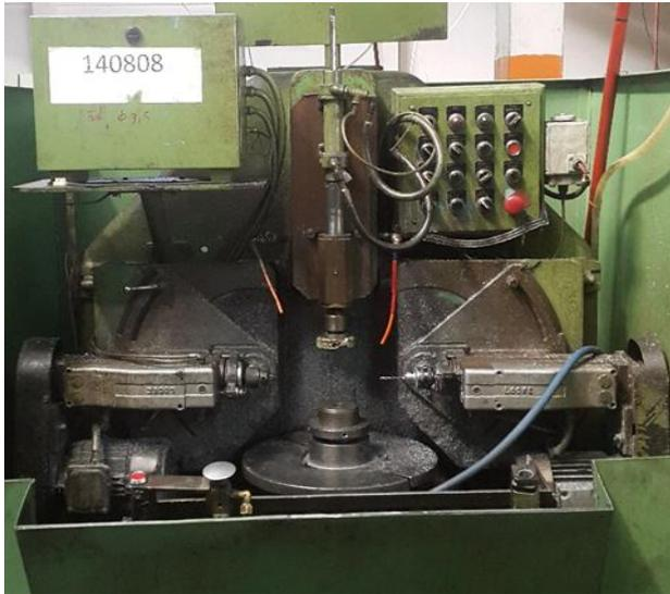
Les perceuses à commande numérique sont diverses au sein de la société. Mais permettent toutes à la finition des trous d'axe des pistons.
