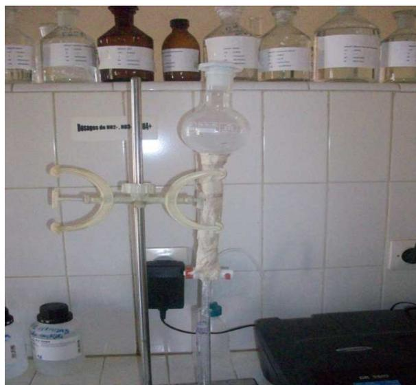
Image 4 : la colonne dans laquelle on fait passer les nitrates
