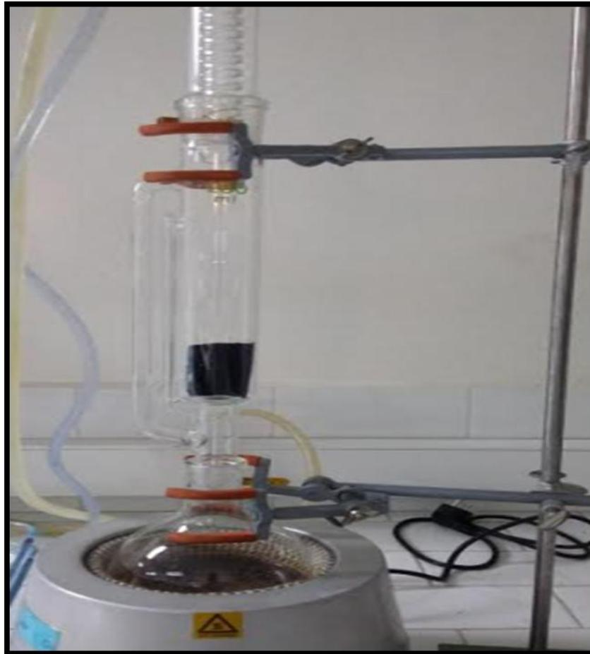
**Photo1 : Extraction par le Soxhlet**
