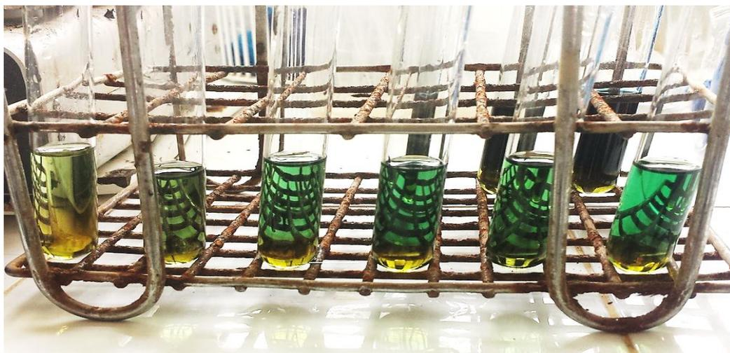
**Figure 12 : Solutions étalons de glucose Après addition du réactif à l'antrone.**
