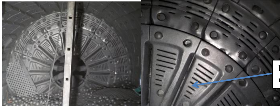
Figure 33-3 : anneau de ventilation
