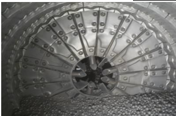
Figure 33-8 : La cloison intermédiaire côté C2 RAS
