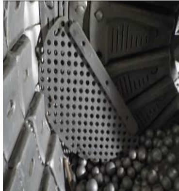
Figure 33-6 : La grille de l'anneau de ventilation RAS
