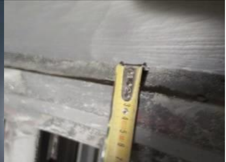
Figure 31-3 : Le jeu de la chicane varie entre 15mm et 20mm
