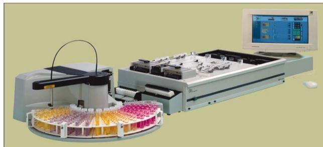
▲ Figure 6 : Analyseur en flux continu (Analyseur San<sup>++</sup> de Skalar)
