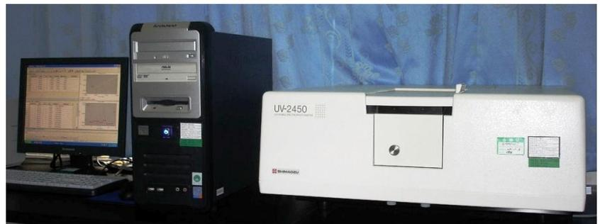
▲ Figure 5 : Photo d'un spectrophotomètre UV-visible simple
