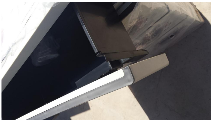
Figure 10 : meuble Majestic : arrachement face du tiroir
