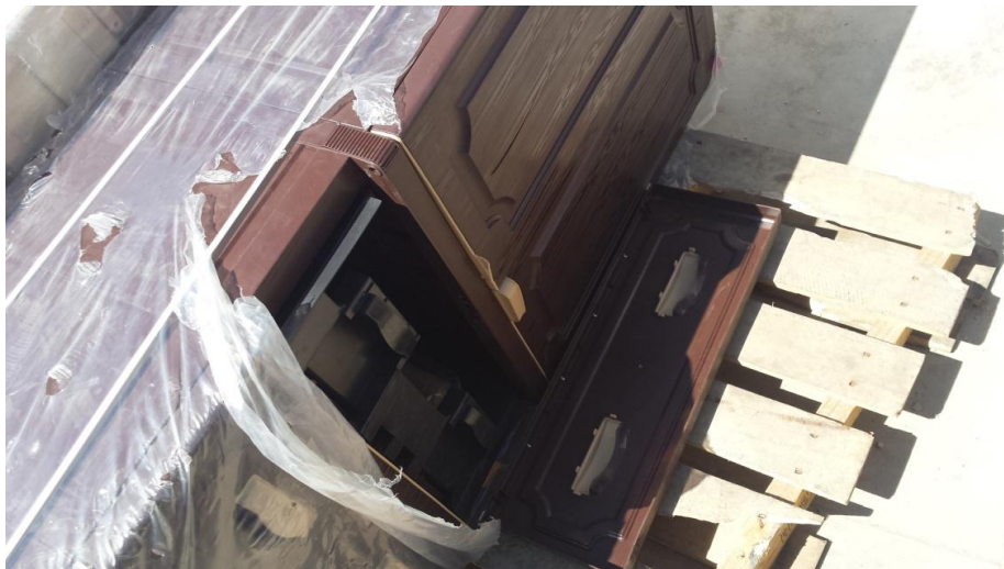
Figure 6 : Meuble comoda prestige : arrachement de la face du tiroir et casse de la poignée
