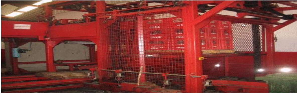
Cette machine représente un système presque automatisé concernant la mise en caisses sur les convoyeurs, ces caissiers sont placés les uns sur les autres sous forme d'un parallélogramme de 6 caissiers sur 4 caissiers pour le volume de 1l et 6 caissiers sur 5 caissiers pour le volume de 35cl et 20cl, ce parallélogramme est posé sur une planche appelée palette.
