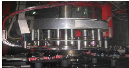
La Sou-tireuse remplit automatiquement les bouteilles sans aucune intervention manuelle de machiniste. Les bouteilles vides entrent dans la Sou-tireuse, puis elles remontent à l'aide d'un piston vers le robinet, grâce à une différence de pression précise, entre le réservoir et la bouteille, quand le liquide atteint un niveau bien précis la pression entre les deux extrémités s'égalise et l'écoulement de la boisson s'arrête.
