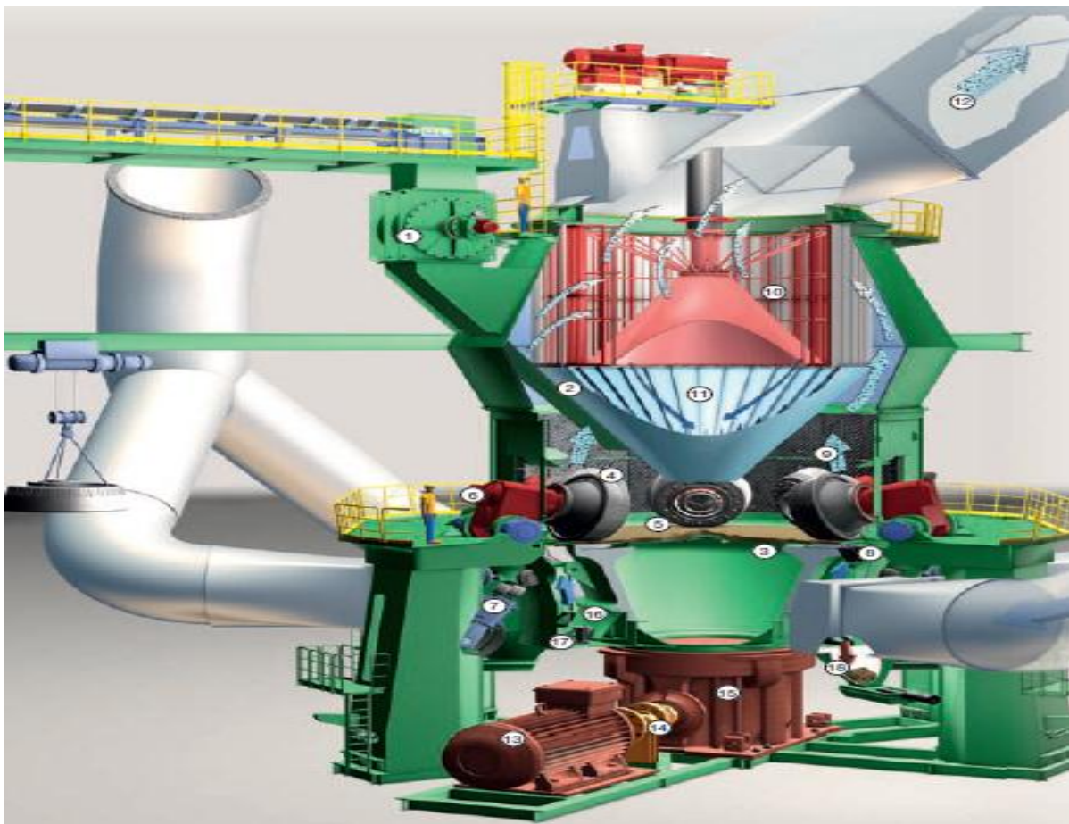
Figure 10 : Broyeur vertical à galets Loesche
