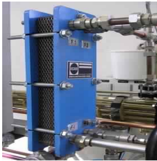
Figure 7: échangeur à plaques utilisé dans la station de traitement de la mélasse.
