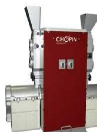
Figure 4 : Moulin de laboratoire CD1.
