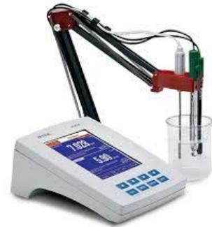
**Mode opératoire :** on lave l'électrode avec de l'eau distillée après chaque mesure, puis on met l'eau à analyser dans un bêcher, ensuite on immerge l'électrode du pH-mètre dans l'eau jusqu'à ce qu'elle soit trompée, et à la fin on lit la valeur affichée sur l'écran après stabilisation.
