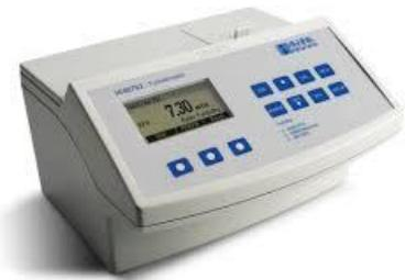
**Mode opératoire :** on remplit le tube avec l'eau à analyser, ensuite on lit la turbidité affichée.
