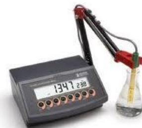
Mesurer la conductivité électrique de l'eau, c'est-à-dire sa capacité à transporter le courant électrique, soit sur le terrain, soit au laboratoire sur des échantillons d'eau prélevés sur le terrain.
