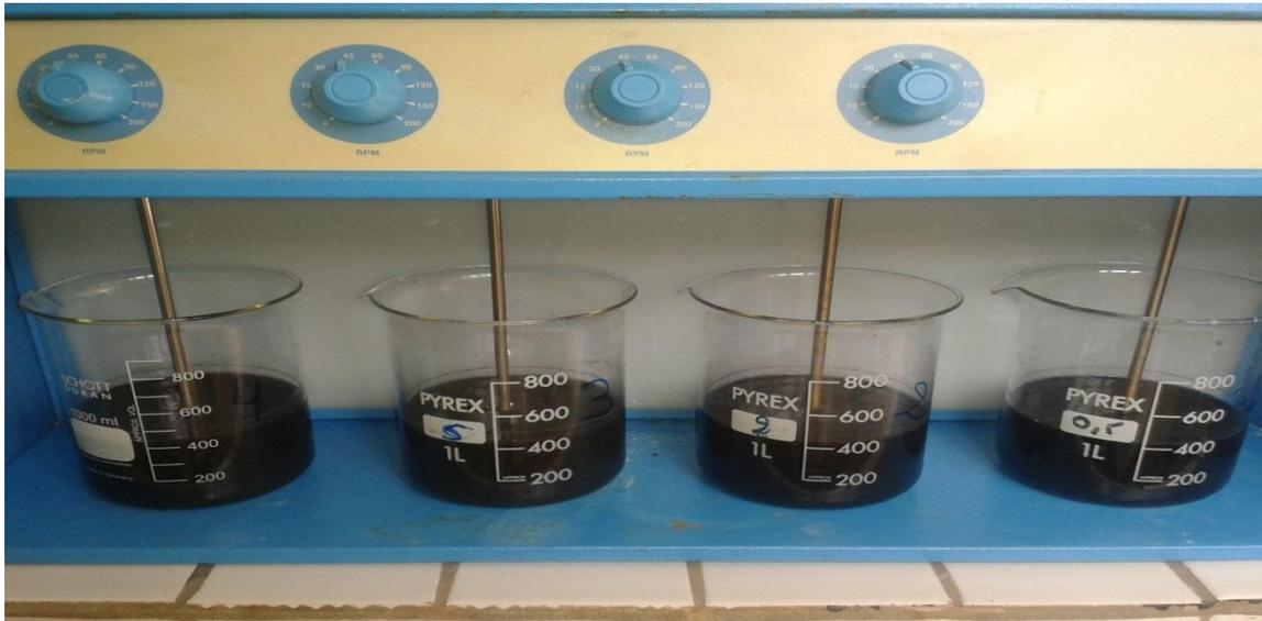
Figure 6 : Appareillage de jar-test
