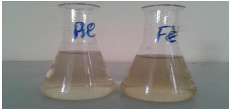
Figure 20 : Margine traitée par électrocoagulation (plaques d'aluminium et de fer)
