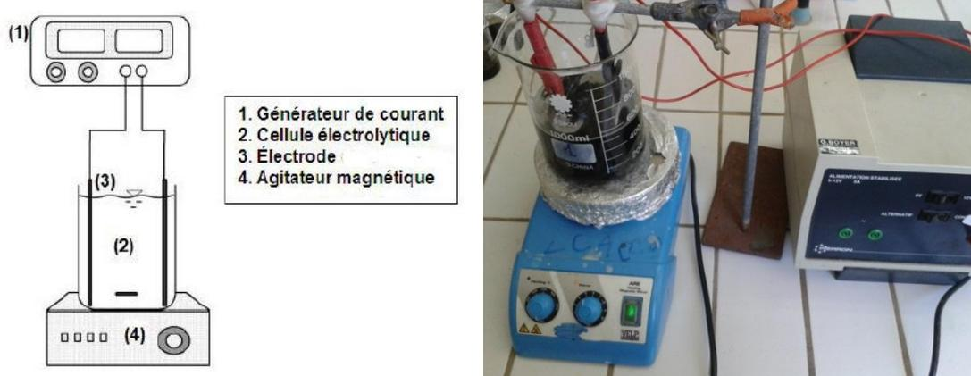
Figure 7 : Cellule d'électrocoagulation
