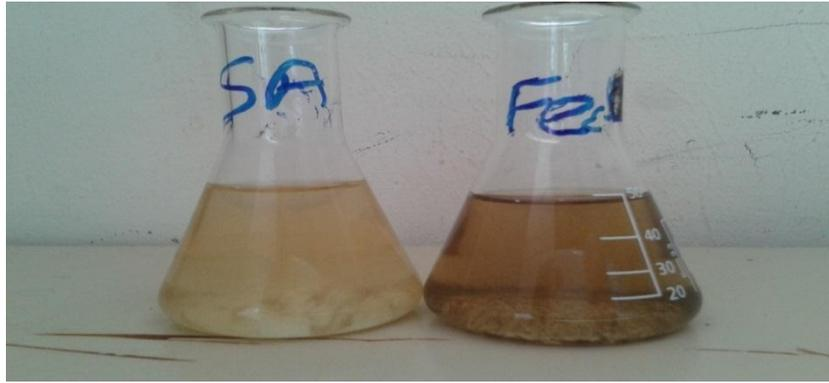
Figure 14 : Margine traitée par coagulation-floculation (le sulfate d'aluminium et le chlorure ferrique)
