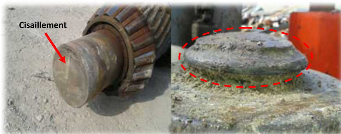
Figure III.2 : Cisaillement de l'arbre d'entrée du réducteur
