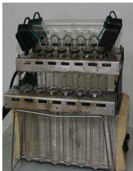
Figure 3 : l'appareil de minéralisation
