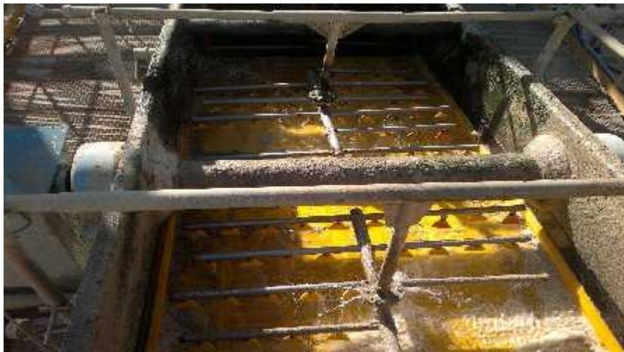
**c-Système d'hydro-classification** : Il assure une coupure réglable de 160 ou 180 $\mu\text{m}$  selon la qualité du minerai traité ou selon la teneur demandée par le client. Sa sou verse va alimenter une batterie d'hydro cyclones HE1 qui joue le rôle d'épaississeur et dont la sou verse constitue le concentré de lavage et alimente les convoyeurs séparateurs. La surverse de HD1 est
