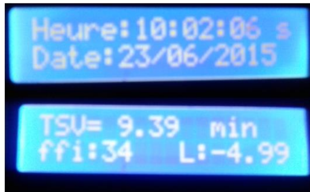
Figure III-15 : Affichage de heure ; date ; temps solaire vrai(TSV) ; latitude de Fès (ffi) ; longitude de Fès(L)
