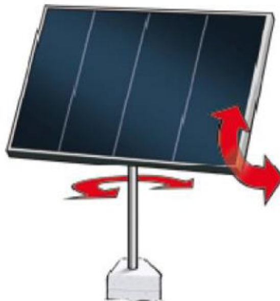
Figure II-8 : Panneau solaire avec système de poursuite bi-axiale
