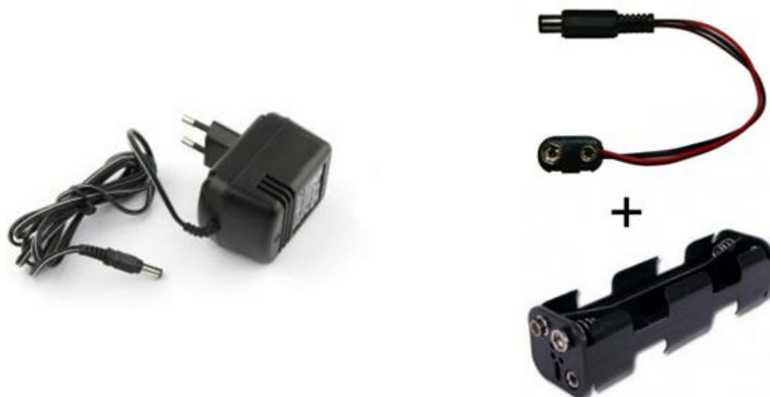
Figure III- 4 : Adaptateur d'une prise jack 2.1mm(à gauche) et connecteur pour des piles (à droite)
