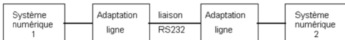
Figure 3.15 : Schéma fonctionnel d'une liaison série asynchrone de la norme RS232
