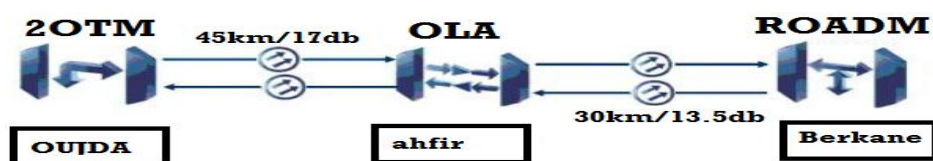
Figure 51 : Schéma de liaison Oujda / berkane
