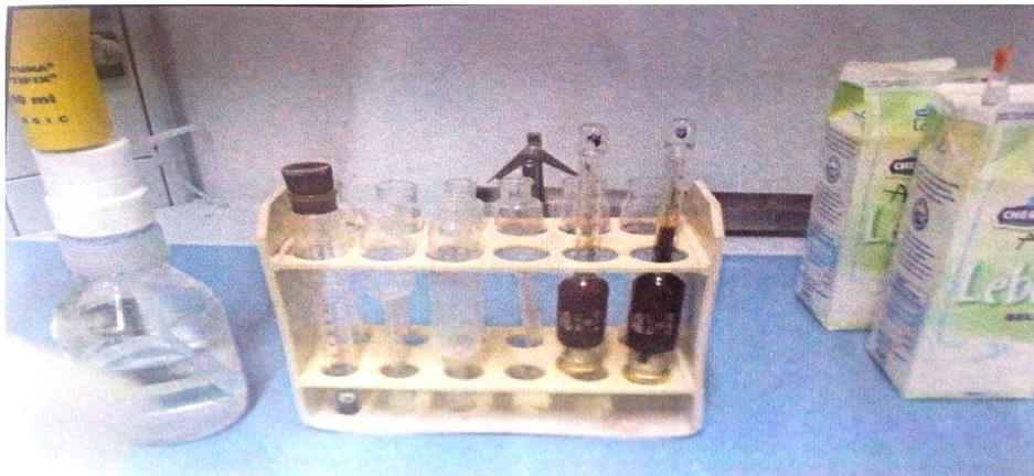
Figure 12 : Mesure de la matière grasse (méthode de gerber)
