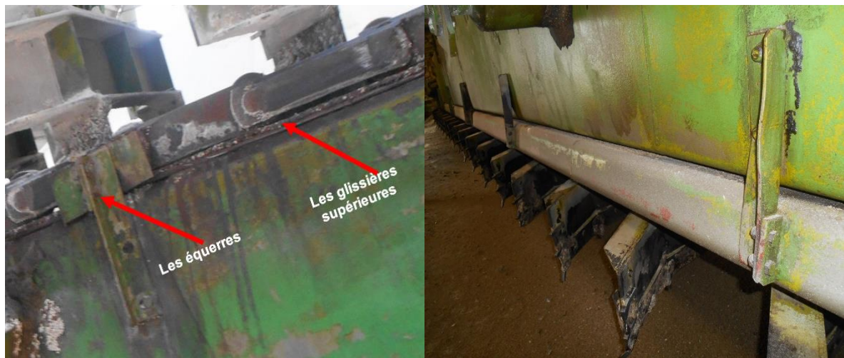
Figure III.3 : Vue sur les glissières
