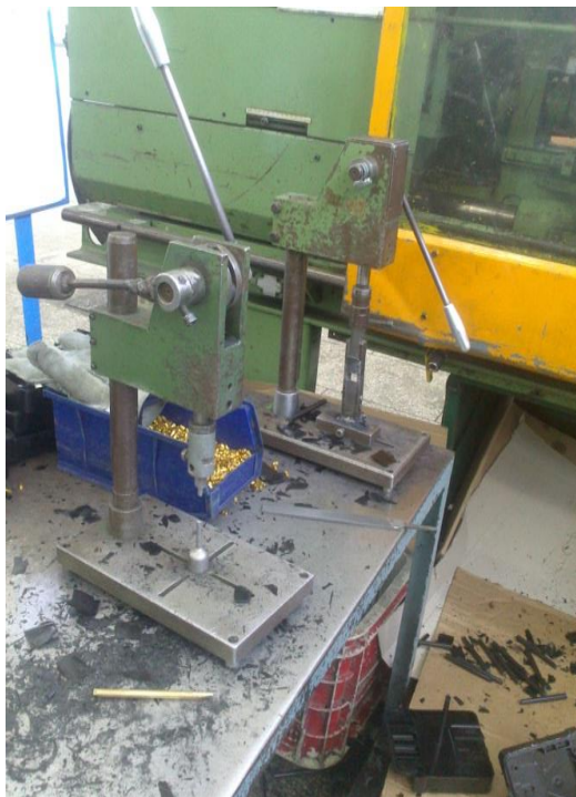
Figure 16 : 2 systèmes manuel pour Fixer les inserts et couper la carotte.
