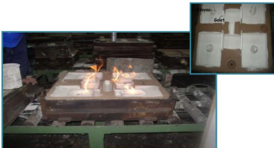
Figure II-7: application et flambage de l'enduit sur l'empreinte
