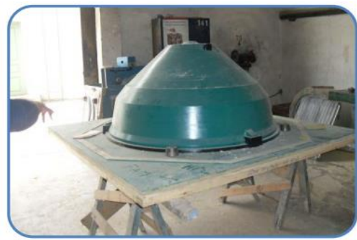
Figure II-5: le plan et le modèle en bois de la pièce
