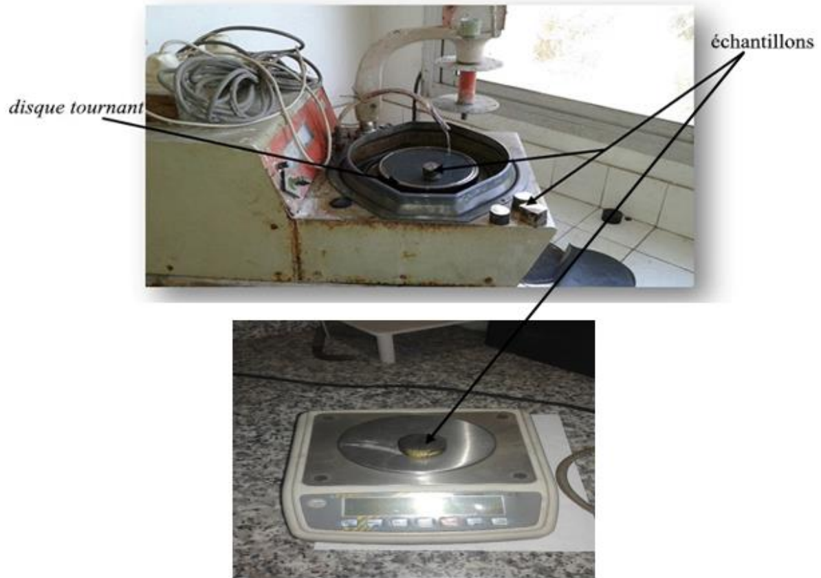
Figure IV-17: dispositif utilisé pour l'essai de l'usure par abrasion
