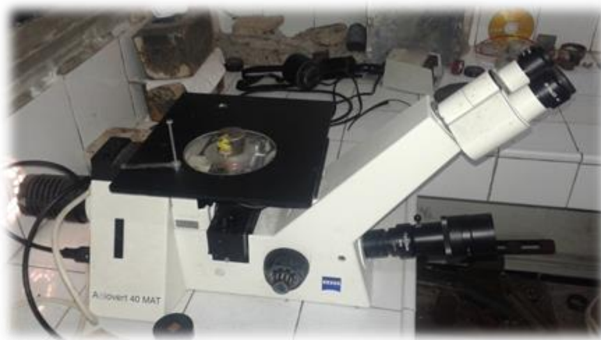
Figure IV-12: le microscope de l'étude métallographique
