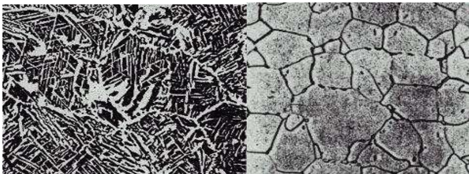
Figure III-14: Micrographie de ferrite aciculaire et granulaire
