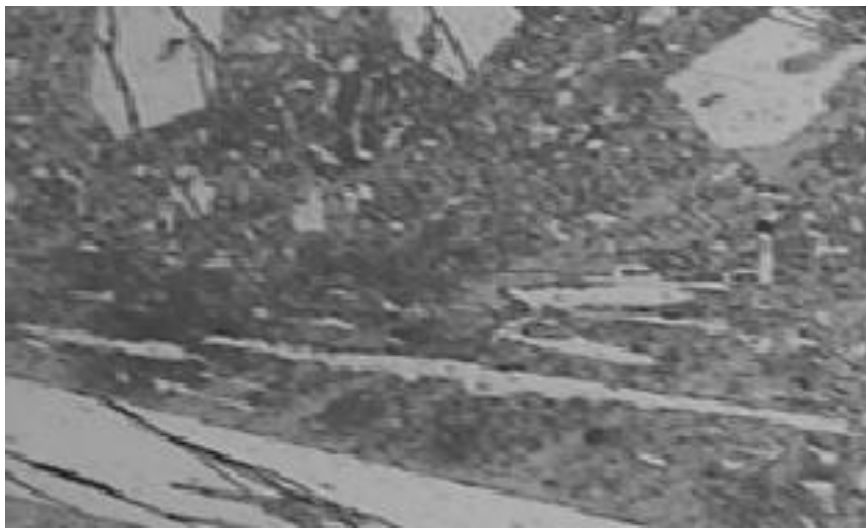
Figure V-11: microstructure de la fonte 2 après la normalisation. Gr : 200
