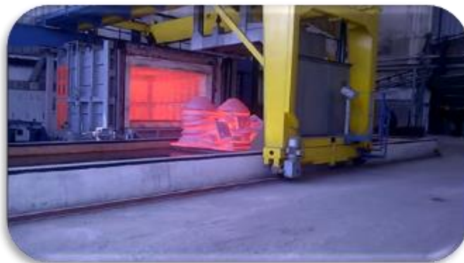
Figure II-17: traitement thermique des pièces de la fonte
