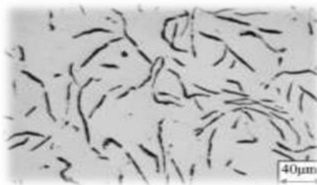
Figure III-4: la microstructure de la fonte graphite lamellaire
