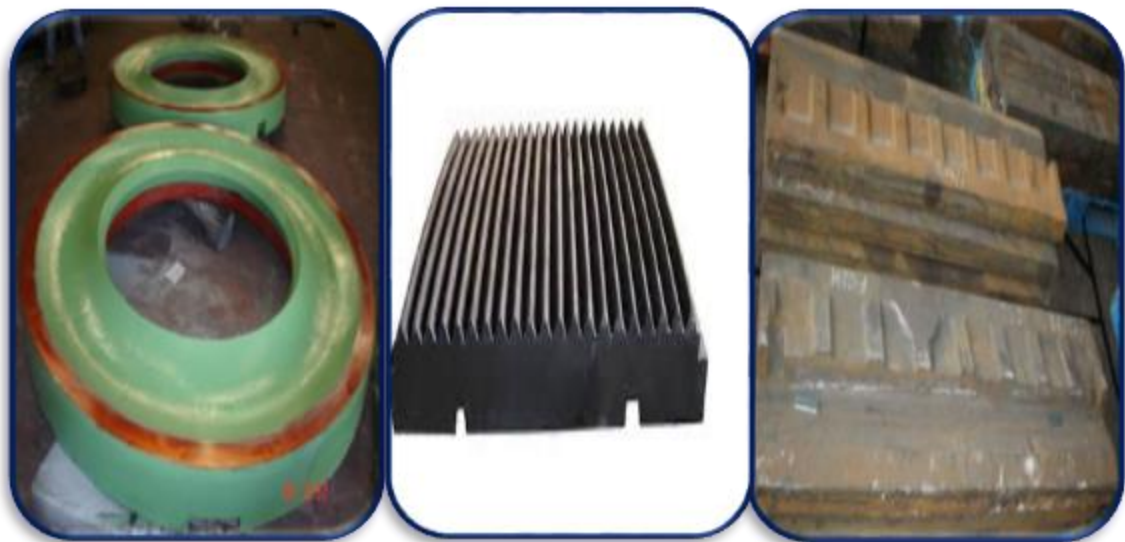
Figure II-3: les pièces de fonte au chrome
