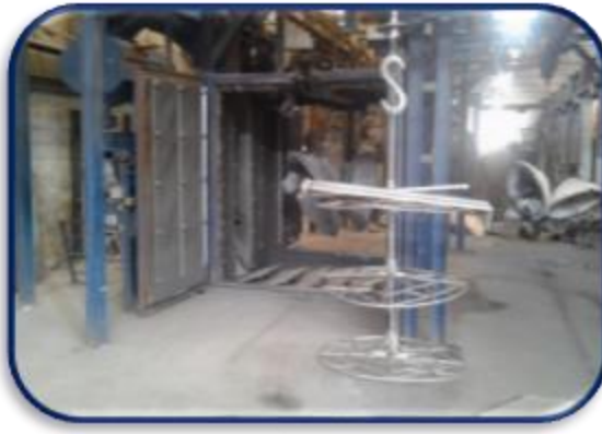
Figure II-15: opération de grenaillage
