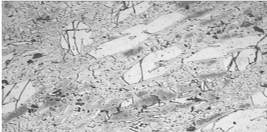
Figure V-15: microstructure de la fonte 2 après normalisation + trempe + revenu. Gr :100
