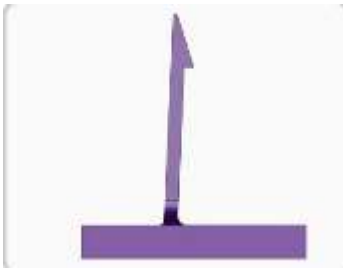
Figure 5 : Clip à crochet en saillie à face perpendiculaire (90°)
