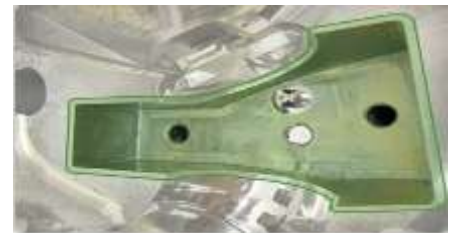
Figure 16: Les zones surlignées contiennent les inserts amovibles que l'on insère manuellement dans le moule avant chaque cycle d'injection
