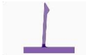
Figure 6 : Clip à crochet à face oblique permettant l'ouverture
