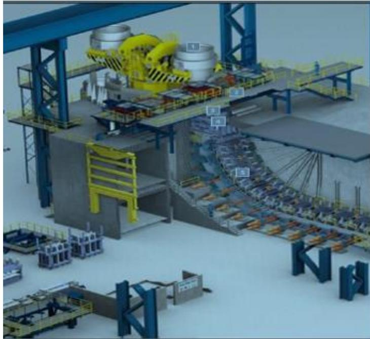
Figure 9 . Schématisation de la machine de coulée continue
