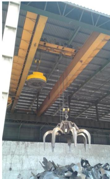
Figure25 . Pont roulant parc à ferraille
