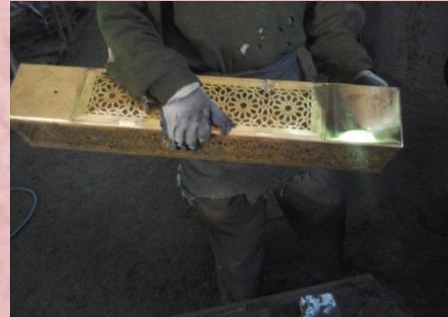
Image 8: la différence entre pièce polie et non polie
