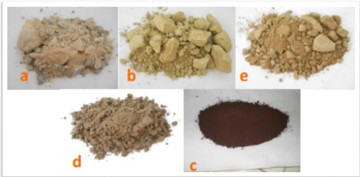
Figure 11 : matière premières constituent le ciment ; a)calcaire,b)argilr, c)schiste, d)sable, e) minerai de fer
