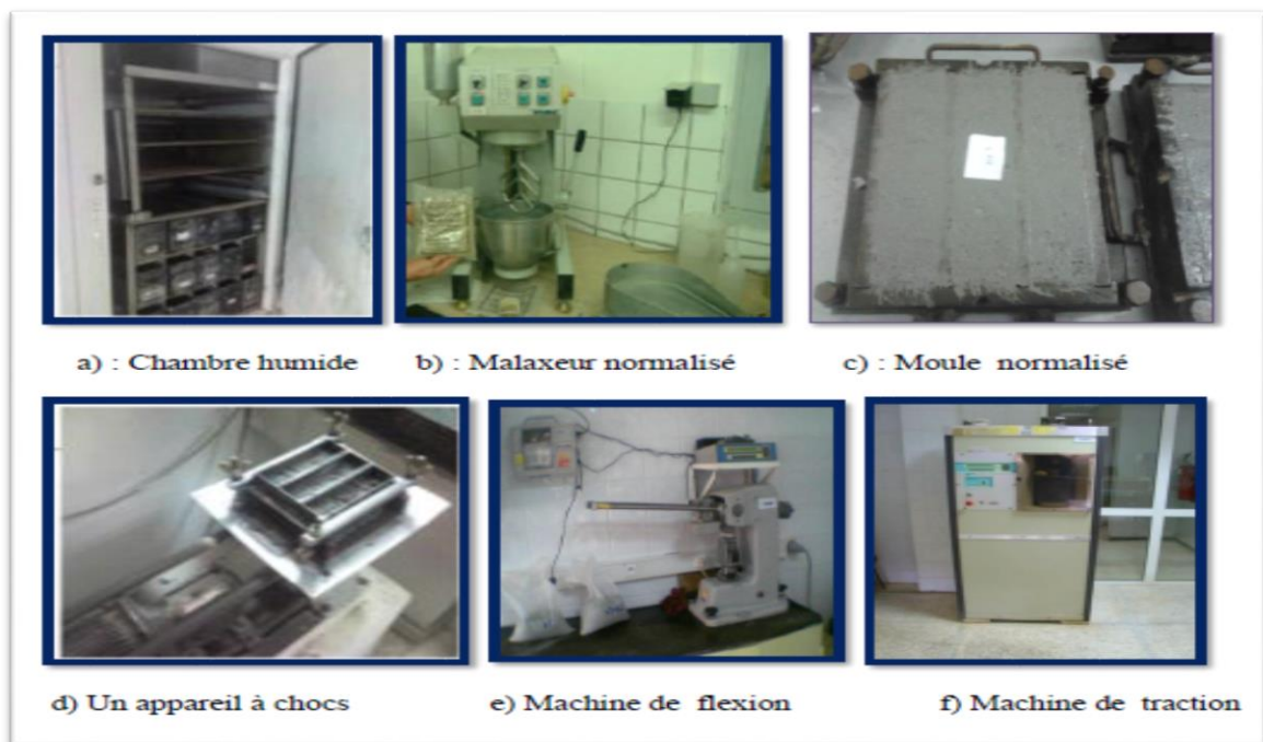
Figure I.3 : Equipement nécessaire pour la résistance
