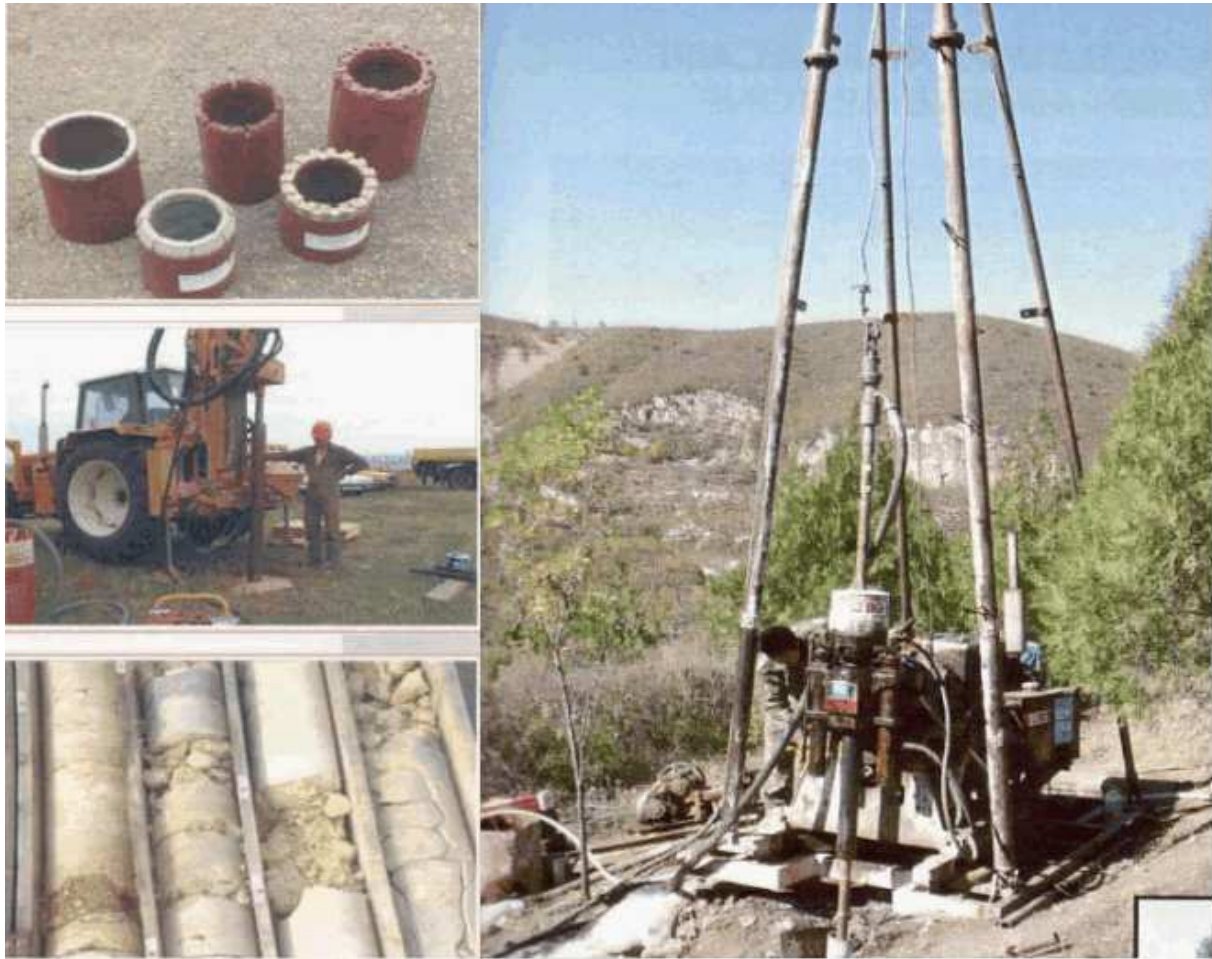
Figure 15 : Sondages carottés (source E. Manier)
