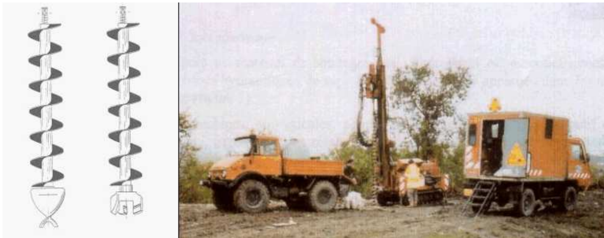
Figure 13 : Sondages à la tarière (source E. Manier)
