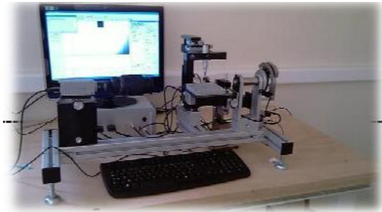
**Figure 7** : Appareil de mesure de l'angle de contact
