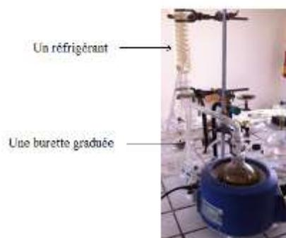
**Figure 17: Dispositif expérimental de l'hydrodistillation avec l'appareil Dean Starck**
