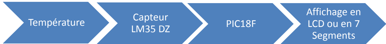
Fig : Chaîne de mesure de température
