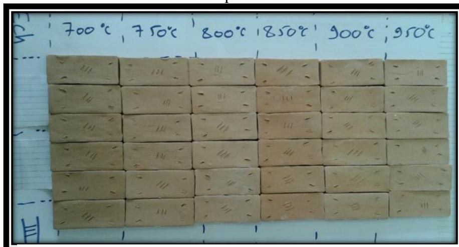
**Photo II.3 :** Couleurs des briquettes d'échantillon III après cuisson à différentes température.
