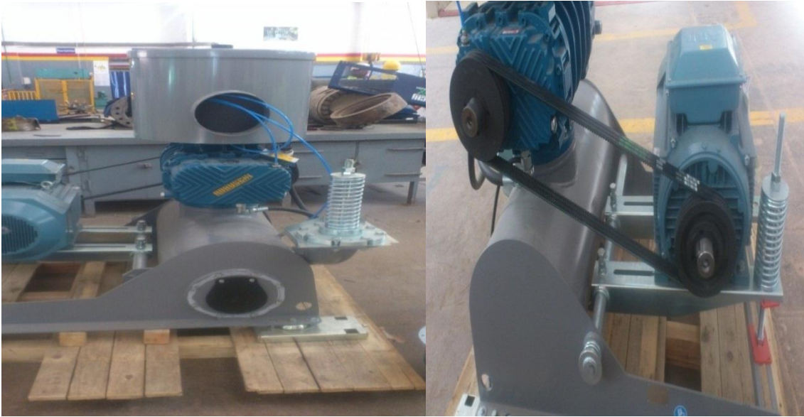
Figure 1-8: Surpresseur et moteur électrique
