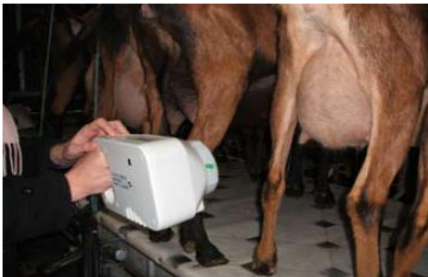
Figure 25 : Prélèvements d'air à l'aide d'un biocollecteur
